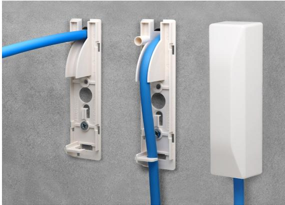
Das FttH 90° Einführungselement bildet eine optisch ansprechende Abdeckung der Rohreinführung ins Gebäude. Es hat einen integrierten Biegeradius zum sicheren Biegen von FttH Mikrorohren oder Kabeln und ermöglicht so das Einblasen der Fasern auch nach der Installation.
