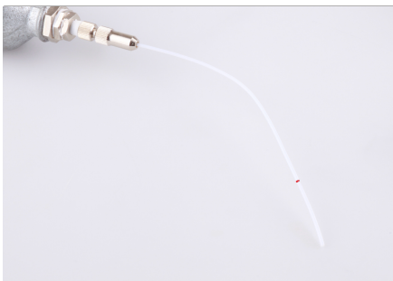
4.7 Füllschlauch der TDUX/ADE mit Schlauchadapter der Druckgasfüllvorrichtung verbinden.
