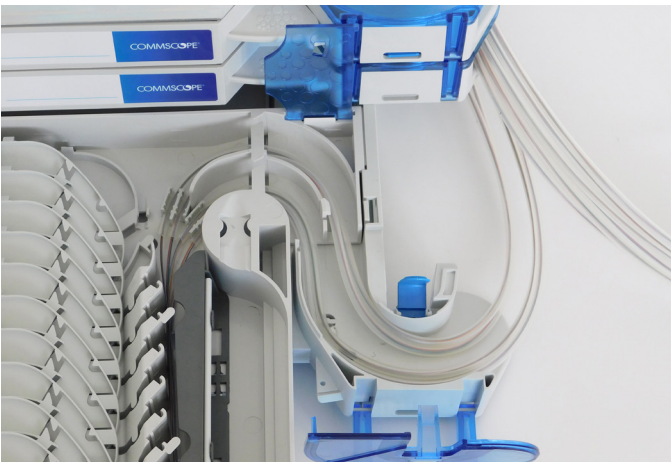
7.4. FOPT-Schläuche in den Kanal des Elementes einlegen und in die FOPT-Halter einrasten.
