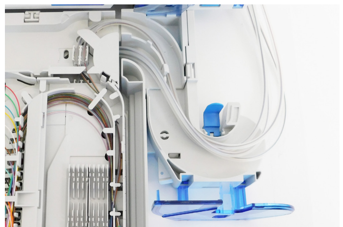
8.7. Die FOPT-Schläuche der Bündelader 3+4 über den inneren Kanal der Schublade zur unteren Kassette führen und in den FOPT-Halter einrasten. Die FOPT-Schläuche müssen bündig mit dem FOPT-Halter abschließen.
