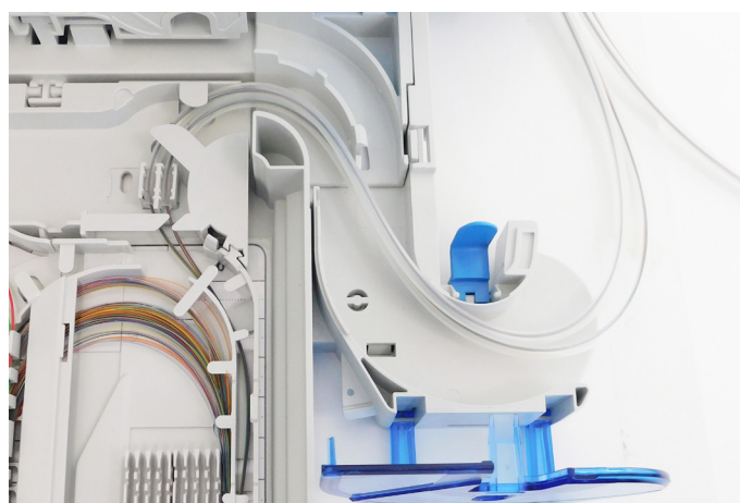
8.3. Die FOPT-Schläuche der Bündelader 1+2 über den inneren Kanal der Schublade zur unteren Kassette führen und in den FOPT-Halter einrasten. Die FOPT-Schläuche müssen bündig mit dem FOPT-Halter abschließen.
