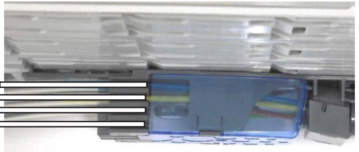
6.7. FOPT-Schlauch bis zum Anschlag vorsichtig in den Halter schieben und Abdeckung montieren.
