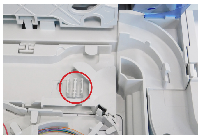
8.2. Klettband öffnen, obere Spleiss-Patch-Kassette hochklappen und flachen FOPT-Halter in die untere Spleiss-Patch-Kassette einrasten.
