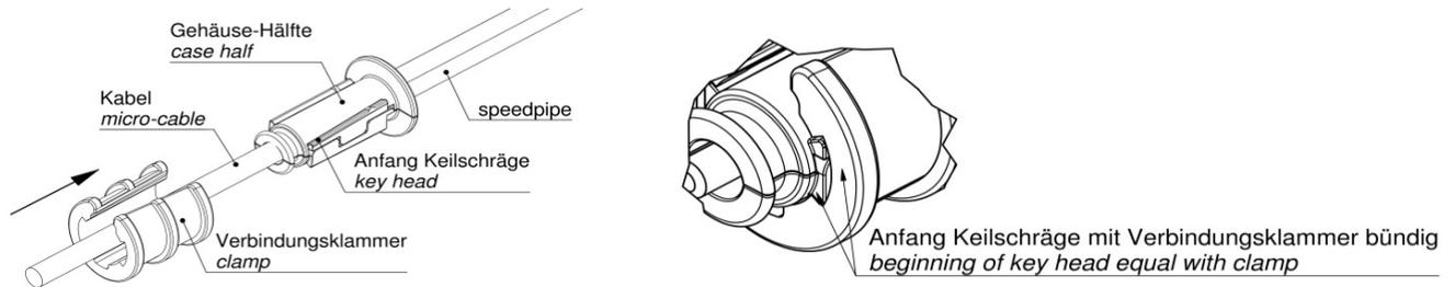
5) Verbindungsklammer über die beiden Gehäuse-Hälften schieben (auf Richtungskennzeichnung achten), bis der Anfang der Keilschräge mit der Verbindungsklammer bündig ist.
