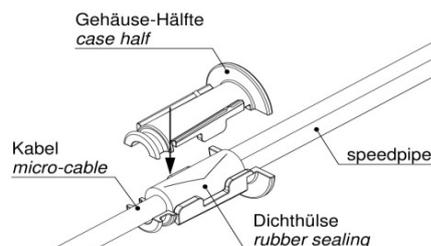
4) Die beiden Gehäuse-Hälften um die positionierten Dichthülse legen. Die Trennkanten des Dichtgummis und die der Gehäuse-Hälften versetzt montieren.
